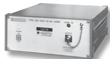
AQ4302 – Helium-Neon-Laser für Kalibrierzwecke, 1992
