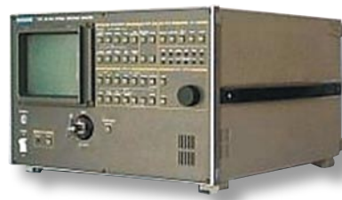
AQ1425 – Optischer Spektralanalysator aus dem Hause Ando für den sichtbaren und infraroten Wellenlängenbereich, 1985
